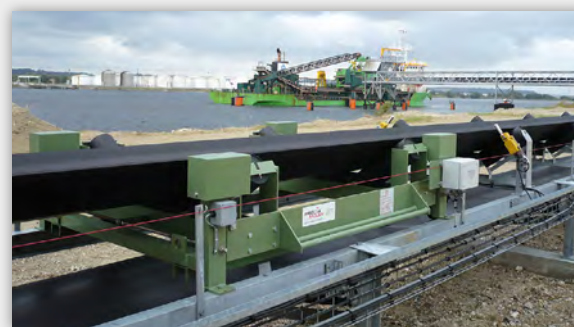
تنها توزین نوار نقاله با دقت \pm 1\% بدون نیاز به کالیبره با مواد
