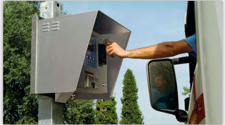
ثابت توزین اول و دوم بدون نیاز به حضور اپراتور با کنترل خودکار انجام شده و راننده با استفاده از کارت بارکد وارد باسکول شده و قبض توزین دریافت می‌کند.
