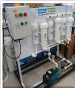
دستگاه تصفیه آب نیمه صنعتی
