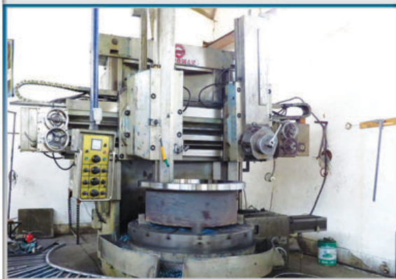
دستگاه کاروسل با قطر کارگیر 1700 KAROSSEL DIAMETER 1700 MM
