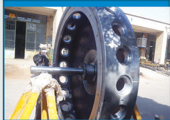
جوشکاری و بالانس قطعه FANCOOLER مجتمع فولاد مبارکه
