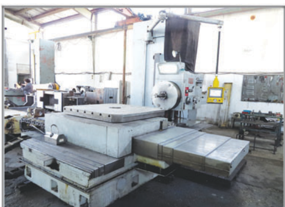
دستگاه بورینگ روسی اسپیندل NC 90 BORING SPINDLE 90 NC 1300MMX1000MM
