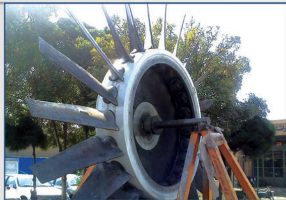
ساخت کامل FANCOOLER و موتازو بالانس مجتمع فولاد مبارکه
