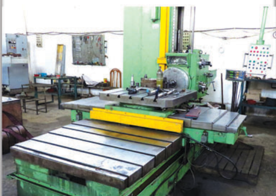
دستگاه بورینگ اسپیندل NC 80 BORING SPINDLE 80 NC 1000MMX800MM
