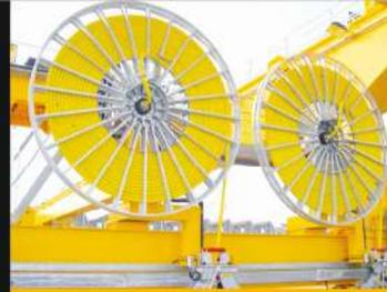
نوع فبرری آن جهت طول مسیر کوتاه و همزمان بر روی کالسکه جرثقیل جهت برقی رسانای فرمان با قدرت به تجهیزات جانبی مانند چنگک و مگنت به کار برده می شود و نوع موتور دار آن عمدتاً در جرثقیل های دروازه ای جهت انتقال طولی برقی تعبیه استفاده می گردد.
