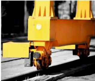
محل قرار گیری آن بر قسمتهای انتهایی پل می باشد. کتلی چرخهای حرکت طولی جراثیل را در خود جای می دهد. ساختار کتلی شامل چرخهده بلبرینگها و یاتاقانها و غیره می باشد.
