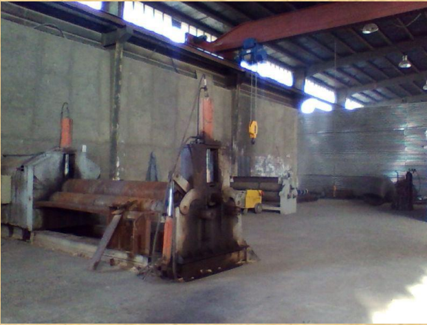
نورد هیدرولیک ۳ متر تا ضخامت ۲۵ میلیمتر
