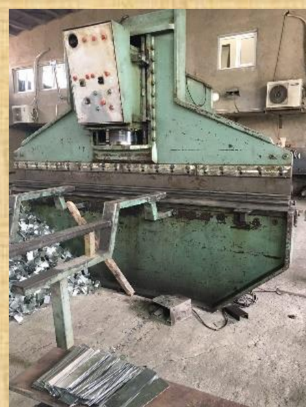
دستگاه خم ۳ متری تا ضخامت ۱۰ میلیمتر
