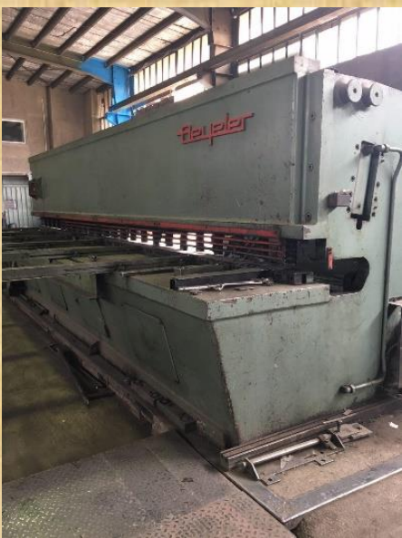
دستگاه گیوتین ۶ متری تا ضخامت ۱۵ میلیمتر
