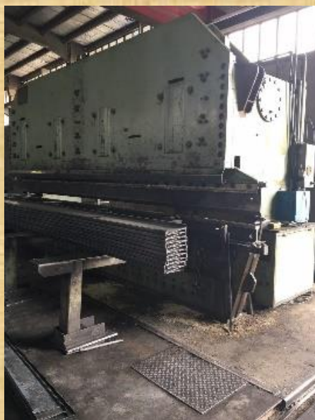
دستگاه خم ۶ متری تا ضخامت ۱۵ میلیمتر
