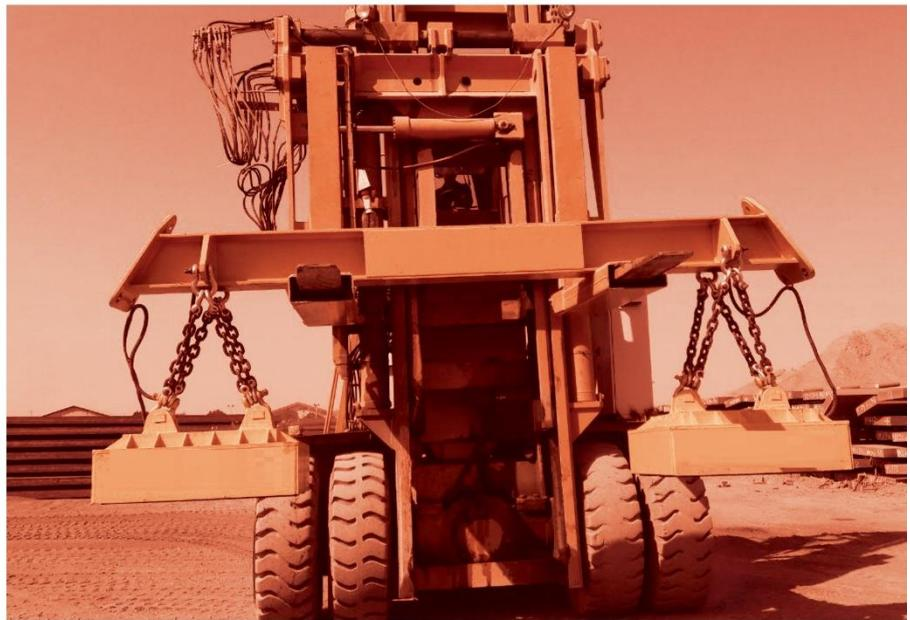
این نوع مگنت به صورت شاهین دار، دوتایی و یا چهارتایی برای حمل ورق های طولی و بلند و لوله ای صنعتی و شاخه ای، میگردد. مگنت مستطیل تکی برای جابه بیلت، بلوک و اسلب نیزاستفاده می گردد. مگنت مستطیل تکی برای جابه جایی ورق، بیلت و اسلب به طول کم استفاده می گردد. در این دستگاه علاوه بر مگنت آن کابل جمع کن، تابلو شارژ، تابلو ترانس، تابلو مقاومت، تابلو تغذیه و جعبه باطری خانه برای حفاظت افراد و تجهیزات که مگنت از روی آنها عبور می کند، طراحی شده است.
