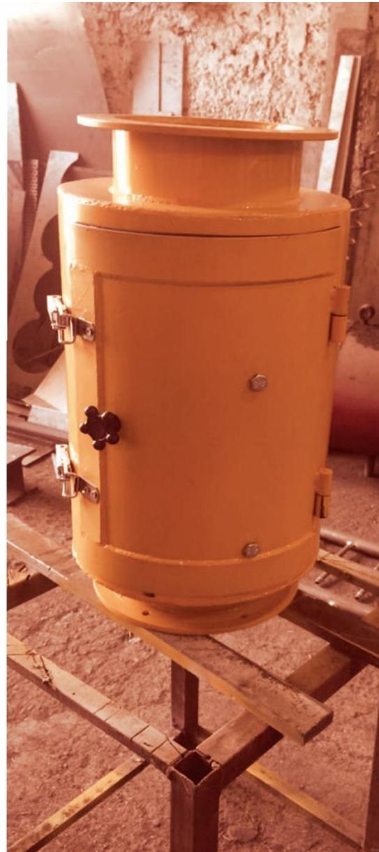
این دستگاه اصلی شامل محفظه (هوزینگ) و مگنت مخروطی شکل تشکیل شده است. این دستگاه که بر اساس قطر کanal عبور مواد و دانه بندی آنها طراحی و ساخته میشود به راحتی در مسیر حرکت مواد قرار میگیرد و ذرات آهنه را جذب مینماید.
